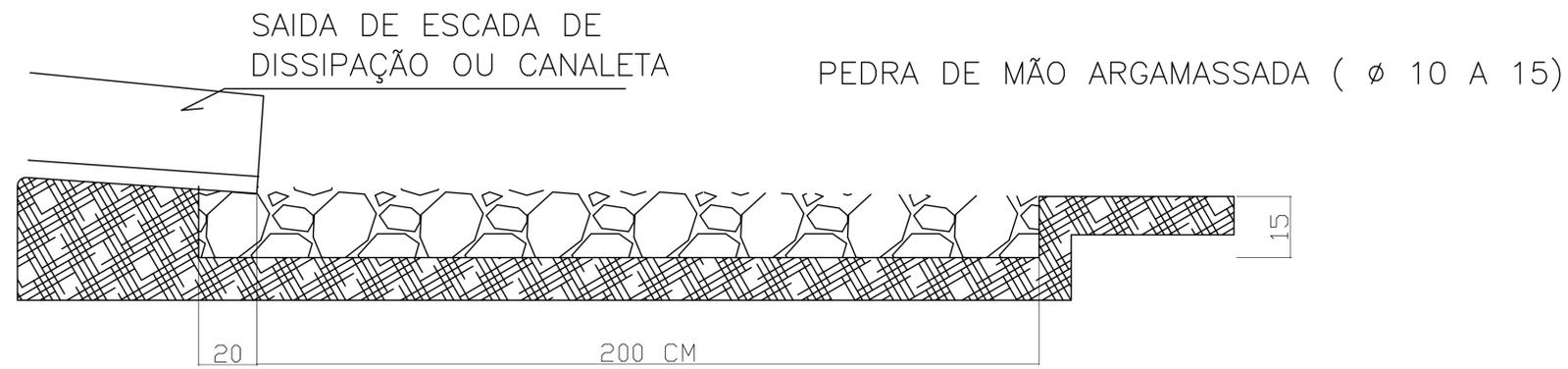
DISSIPADOR DE ENERGIA TIPO DES 02
