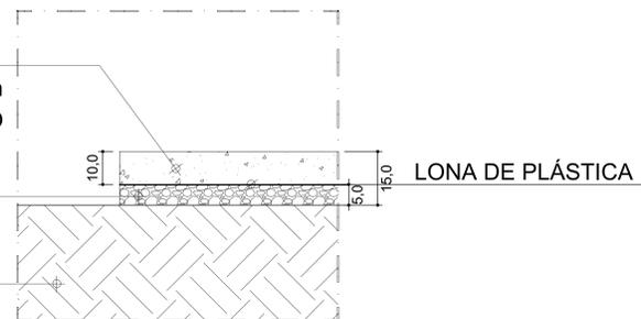
CORTE ESQUEMÁTICO DO PISO SEM ESCALA
